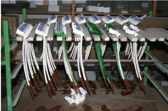
Goedewaagen-Lakpunten in productie voor Nederlandse Federatie voor Pijprokers en Gouds Groene pijpen, met afgelakte mondstukken
